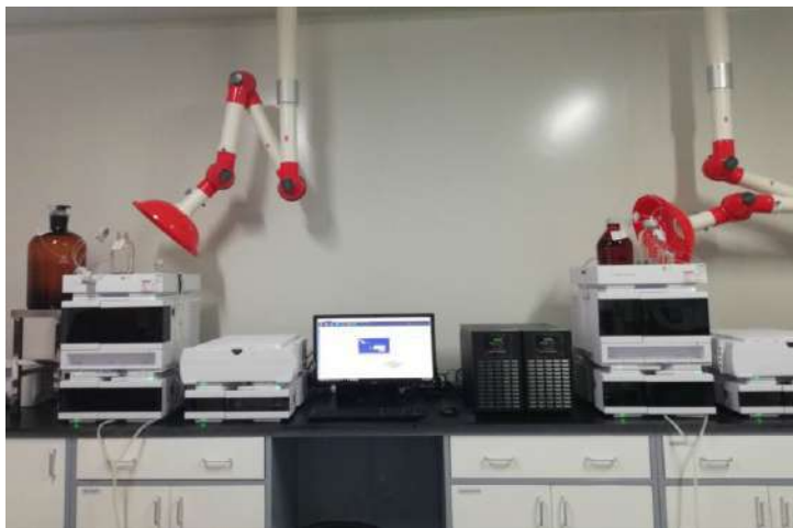
HPLC主要用于化验和有关物质的检测
