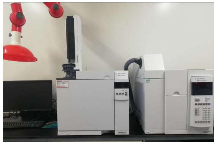
GC主要用于残留溶剂检测
